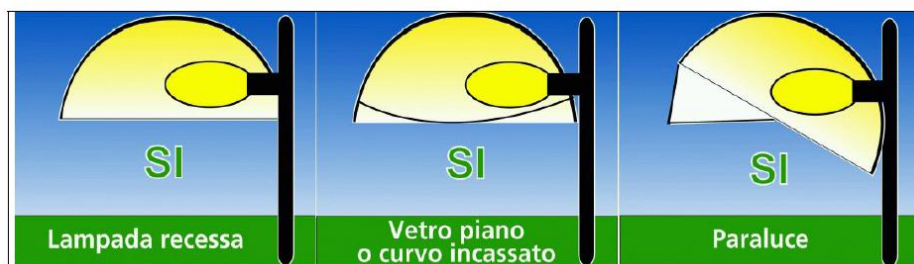
Fig.2 – Apparecchi conformi alla L.r. 17/09.
